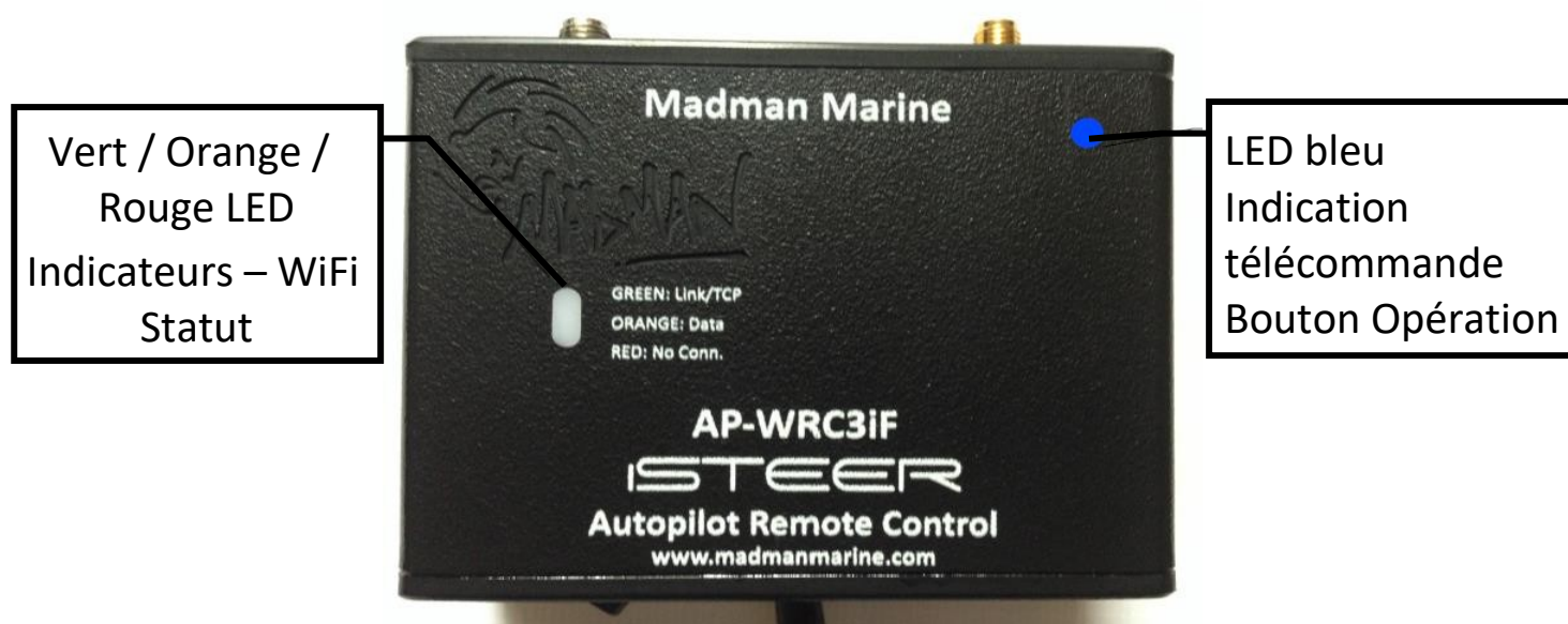
Figure 6: Indicateurs Led de l'unité de base AP-WRC3iF
